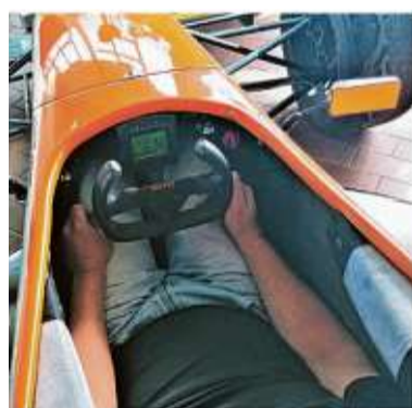
Sardinienbüchse: Trotz der Enge im Cockpit muss geschaltet und gelenkt werden. Auch die Motorlöschanlage kann von dort aus betätigt werden.
