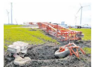
Beim Rückbau eines Windrades im März 2022 war ein 500-Tonnen-Schwerlastkran mit weit ausgefahrenem Ausleger in dem Windpark bei Elsterwerda-Kotschka umgestürzt. *Foto: vrs*
